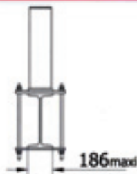
Fixation par deux brides en acier galvanisé et 4 tiges filetes M12
