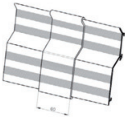
Figure 4 - Assemblage jonction droite
