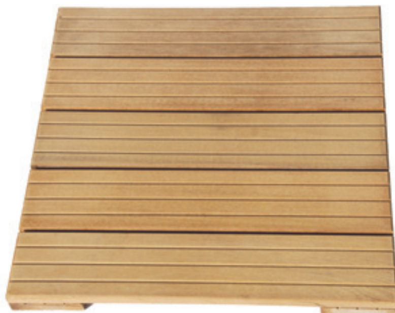
DALLE ITAUBA 40 X 500 X 500 mm Rainurage 3V 5 lames de parement 20 x 96 mm 2 Traverses IPE 20 x 96 mm - 20 Vis inox 4/32 Poids - environ 5.90 kg / dalle
