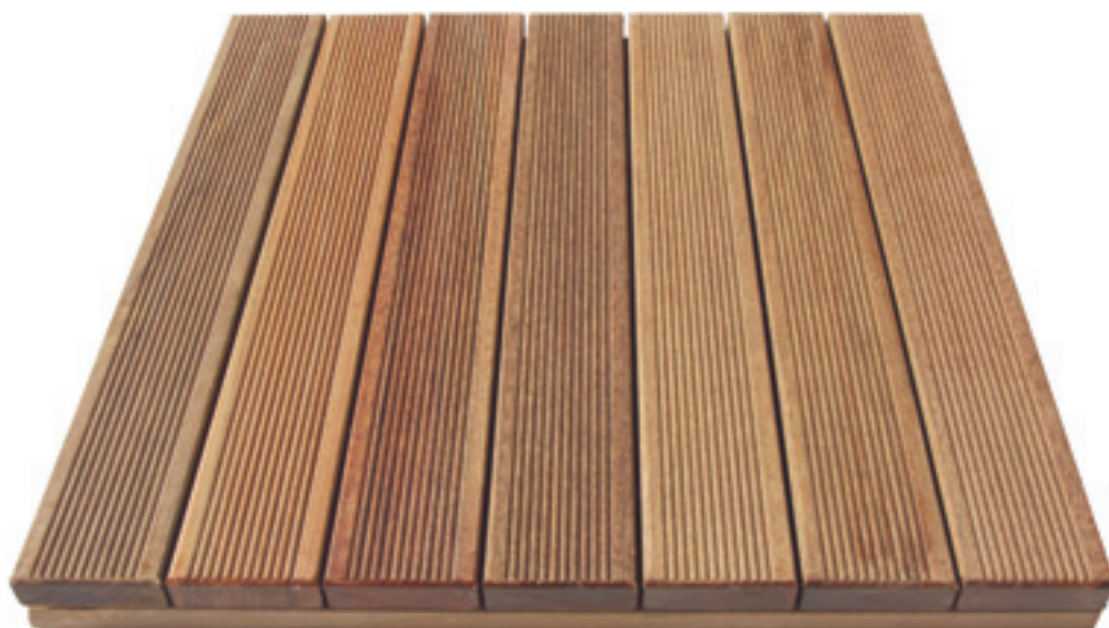
DALLE IPE 40 X 500 X 500 mm Rainurage peigne 7 lames de parement 20 x 68 mm 2 Traverses IPE 20 x 68 mm - 28 Vis inox 4/32 Poids - environ 6.30 kg / dalle
